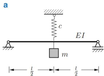
Durchbiegung (Balken) und Auslenkung (Feder) sind gleich gross → Parallelschaltung
