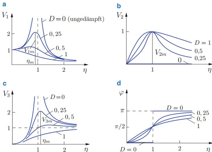
Abb. 5.23 Vergrößerungsfunktionen und Phasenverschiebung
