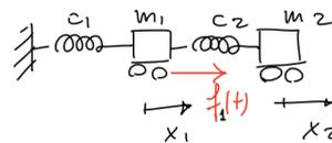
$$[M] = \begin{bmatrix} m_1 & 0 \\ 0 & m_2 \end{bmatrix} \quad [C] = \begin{bmatrix} c_1 + c_2 & -c_2 \\ -c_2 & c_2 \end{bmatrix}$$
