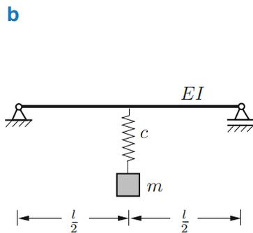
Durchbiegung (Balken) und Auslenkung (Feder) sind gekoppelt → Reihenschaltung
