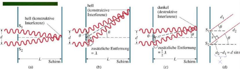
Helle Streifen (Maxima):  $\Delta L = d \cdot \sin \theta = m\lambda$  mit  $m=0,1,2,\dots$
