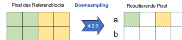
Abbildung 10: Downsampling Beispiel (4:2:0) (Achtung, kann nur bei Cb+ Cr gemacht werden, Y bleibt gleich gross)
