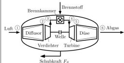
Diffusor Verdichter isnetrope Verdichtung ohne Arbeitszufuhr isentrope Verdichtung mit Zufuhr der Arbeit, die die Turbine abgibt isobare Wärmezufuhr
