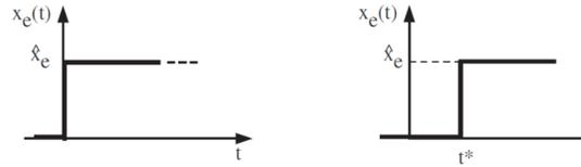
Stellt z.B. einen Schalter dar, der zum Zeitpunkt  $t = 0$  oder  $t = t^*$  eingeschaltet wird.
