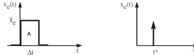
Der tatsächliche Wert von  $x_e(t)$  kann hier durch berechnung der Fläche  $A$  bestimmt werden:
