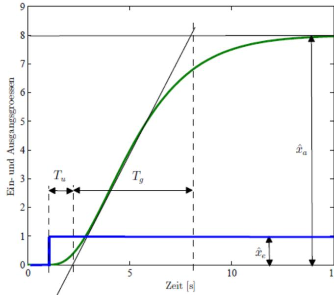
Die Statische verstärkung  $K_{sn}$  eines PTn-Systems ist definiert durch:
